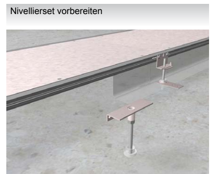
Nivellierset vorbereiten Nivellierstift mit Mutter SM M8 und Dämmhalter ZE-D versehen. Nivellierstift in Stützwinkel einschrauben.
